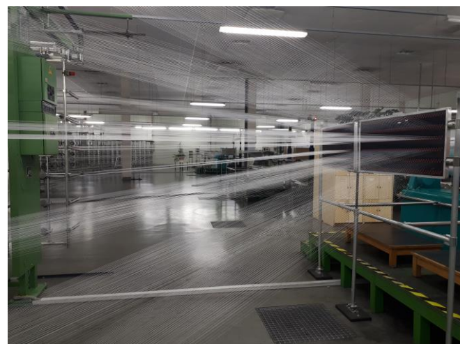
Trevira GmbH; Schärerei, Schärfäden
