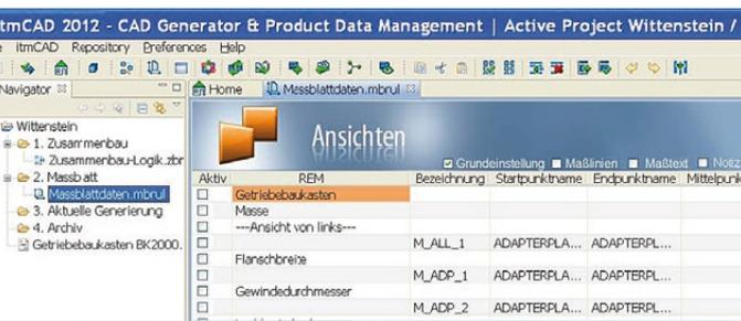
*Zur automatischen Erzeugung von Maßblättern werden wertabhängige Bemaßungsregeln erstellt und gespeichert*
